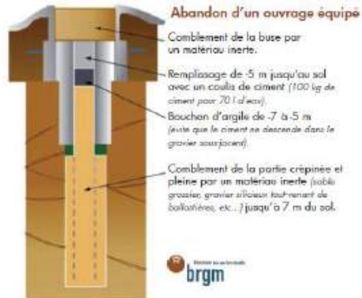
Figure 3 : Techniques de comblement d'un puits, source : Le forage d'eau en Basse-Normandie, octobre 2013
